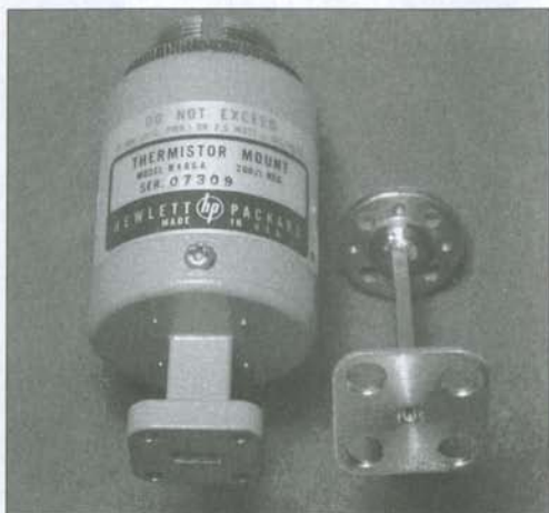
Fig. 7 Waveguide flange for HP R486A Abb. 7 Hohlleiter-Flansch für HP R486A
