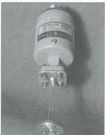
Fig. 8 flange connected to HP R486A Abb. 8 Messkopf mit WR12
